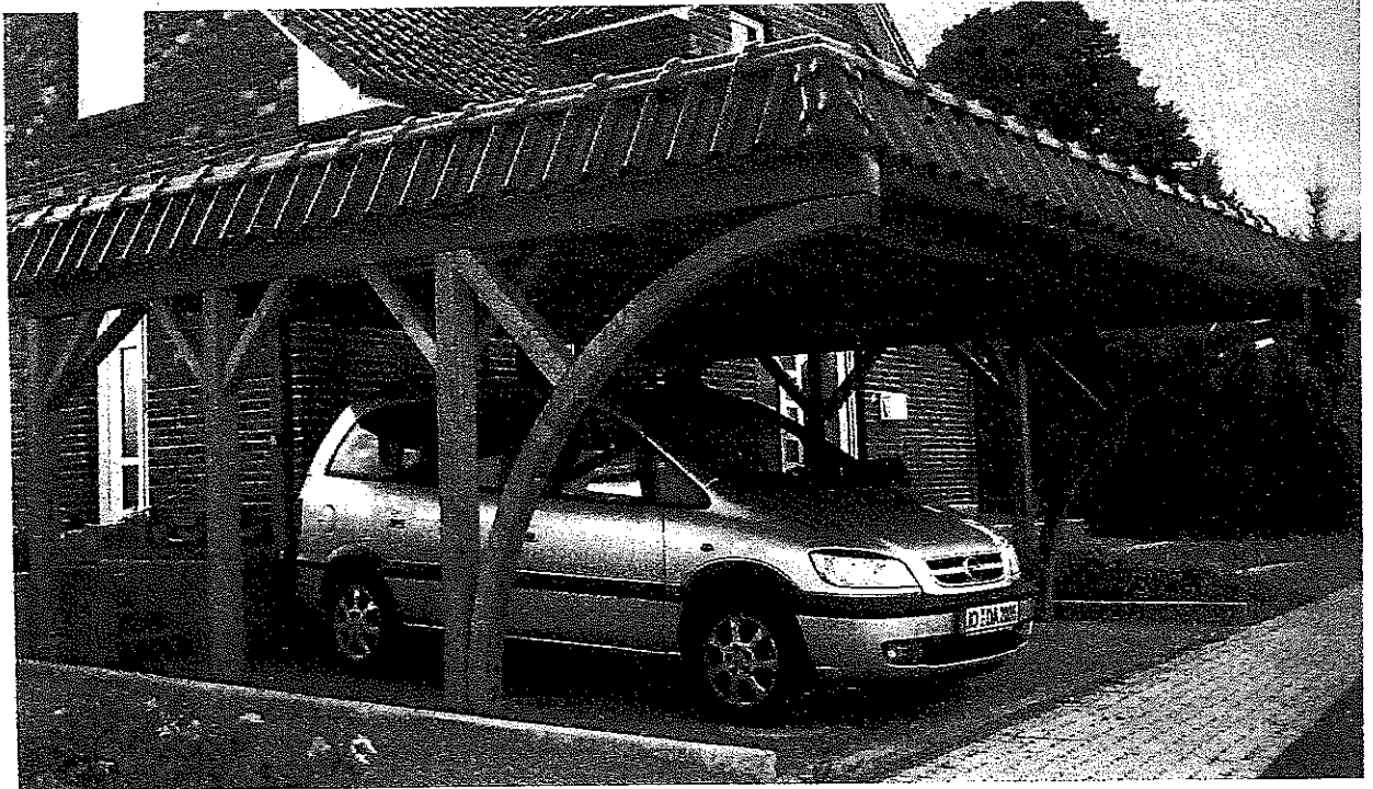
Breite Einfahrt: Pfostenbogen aus Leimholz. Als bewährte praktische Alternative zum herkömmlichen Pfosten bei engen Einfahrten inkl. verstärkter Konstruktion / geänderter Pfostenabstände. Lieferbar für Standard-Durchfahrthöhe von 210 cm. Rechenbeispiel s. Tabelle
