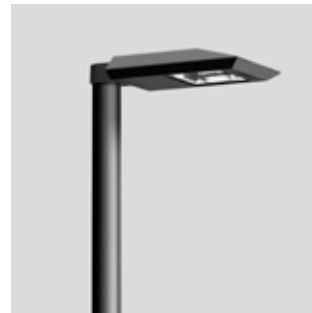
Aufsatzleuchten aus Aluminium und Edelstahl (pulverbeschichtet in DB 703 anthrazit) mit entspiegelter ESG-Verglasung und Reflektor aus eloxiertem Reinstaluminium. Lichtstärkeverteilung asymmetrisch-bandförmig. Es kann die Mastleuchte 84252K3 der Firma BEGA verwendet werden.
