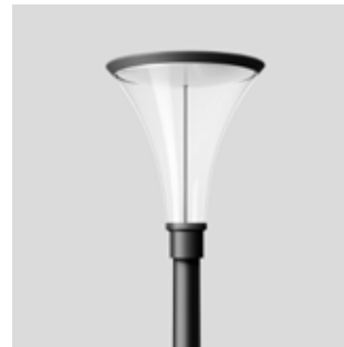
Aufsatzleuchten aus Aluminium und Edelstahl (pulverbeschichtet in DB 703 anthrazit) mit einer klaren zylindrisch unten zulaufenden Kunststoffabdeckung mit einem Reflektor aus eloxiertem Reinstaluminium. Die Lichtstärkeverteilung ist asymmetrisch-bandförmig. Es kann die Mastleuchte 84252K3 der Firma BEGA verwendet werden.
